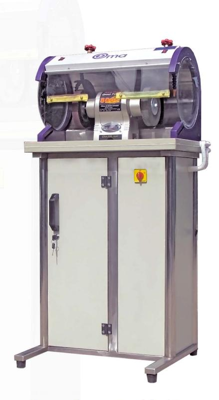
Sprue Removing Machine เครื่องเจียรก้านทางเดินน้ำ
